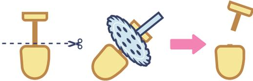
**B** Desgasta la unión sobrante del prensado.
